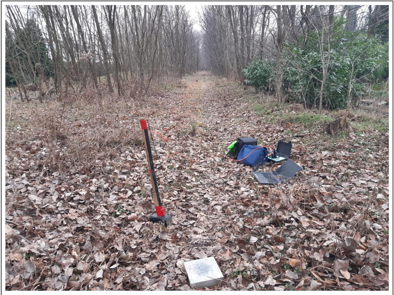
*Fig. 12.1 - Stendimento sismico ed attrezzatura utilizzata*
