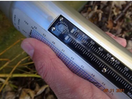
Si è provveduto a verificare, mediante delle prove sclerometriche, le caratteristiche del calcestruzzo della struttura del ponte, in modo da accertare la compattezza dei materiali presso i quali si prevede di ancorare le staffe in acciaio inox in progetto.
