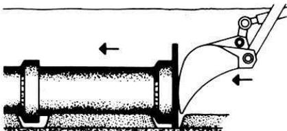
Eeguire la giunzione introducendo la punta nel bicchiere e spingendo il tubo a mano per mezzo di una leva.
