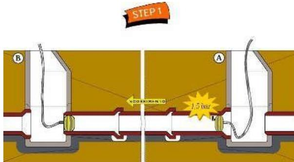
Predisporre, sui due cuscinetti, un opportuno sistema di contrasto della spinta idraulica (Vedi tabella Step 4) Collegare il tubo piezometrico alla testata di prova
