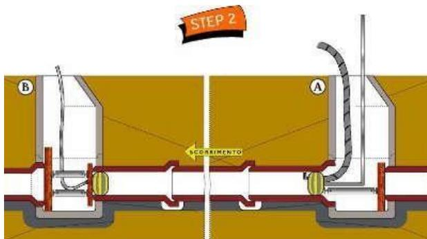
Procedere al riempimento della tratta sino a superare di qualche centimetro il colmo della condotta. Riempire la colonna piezometrica fino ad un'altezza di 5 m. (0,5 bar)
