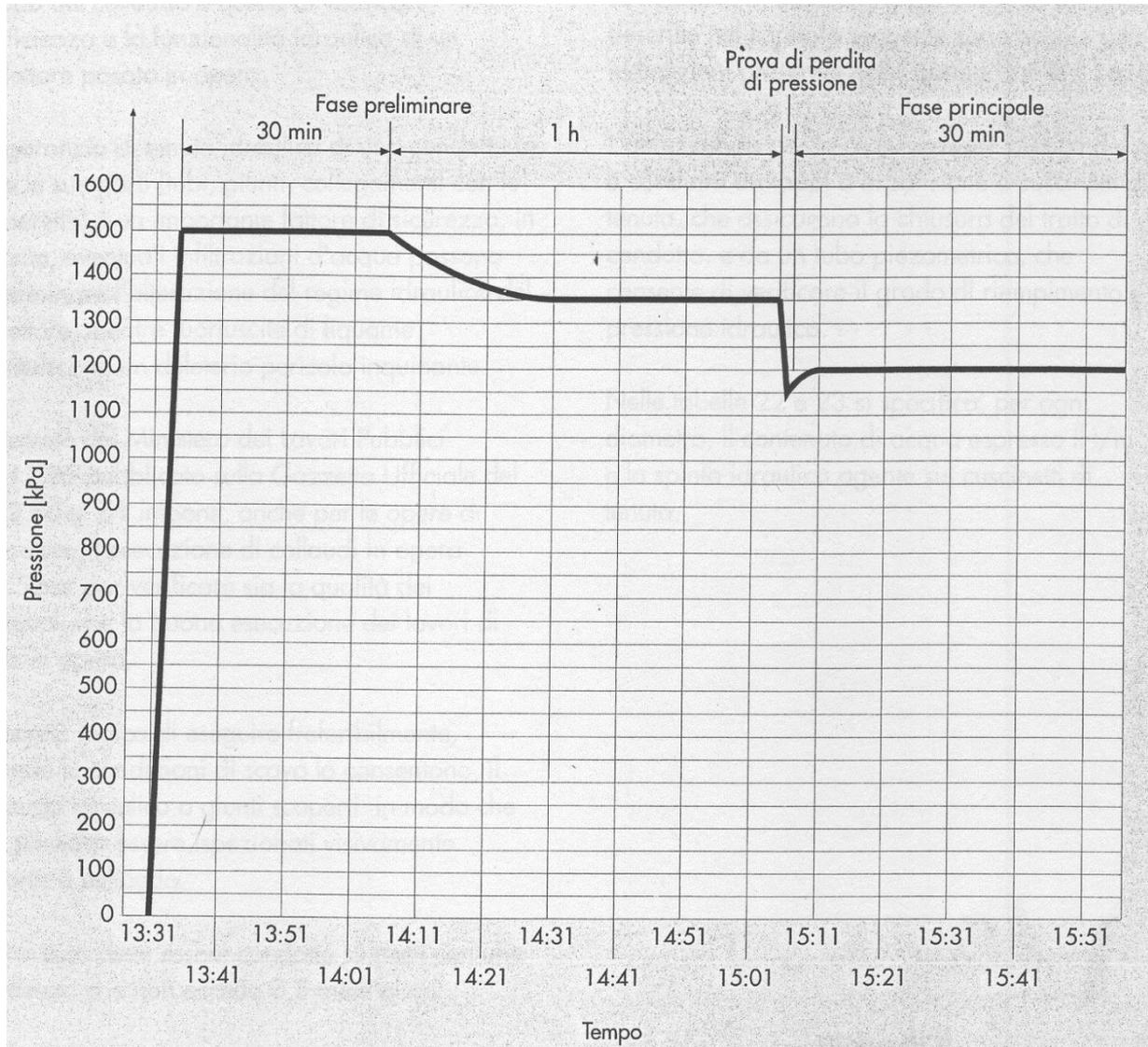
È importante che la prova si esegua quanto possibile in condizioni di temperatura controllata (normalmente 12 – 15°C) poiché la temperatura influenza notevolmente i parametri coinvolti in questo collaudo.
