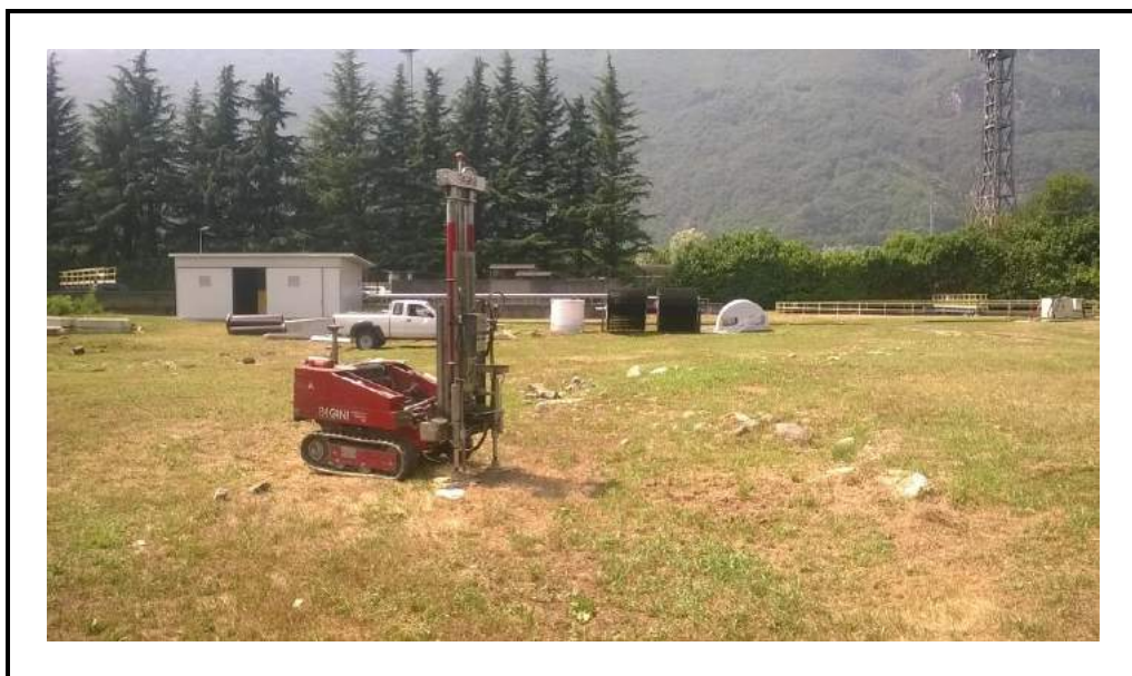
Foto 9: Postazione prova penetrometrica DPSH 2 bis.
