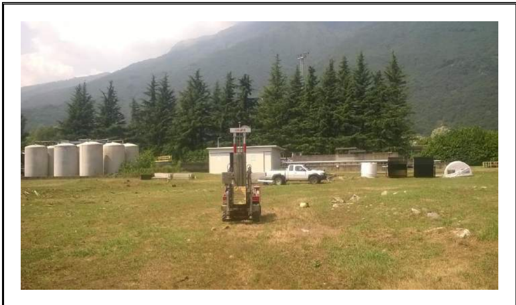
Foto 8: Postazione prova penetrometrica DPSH 2.
