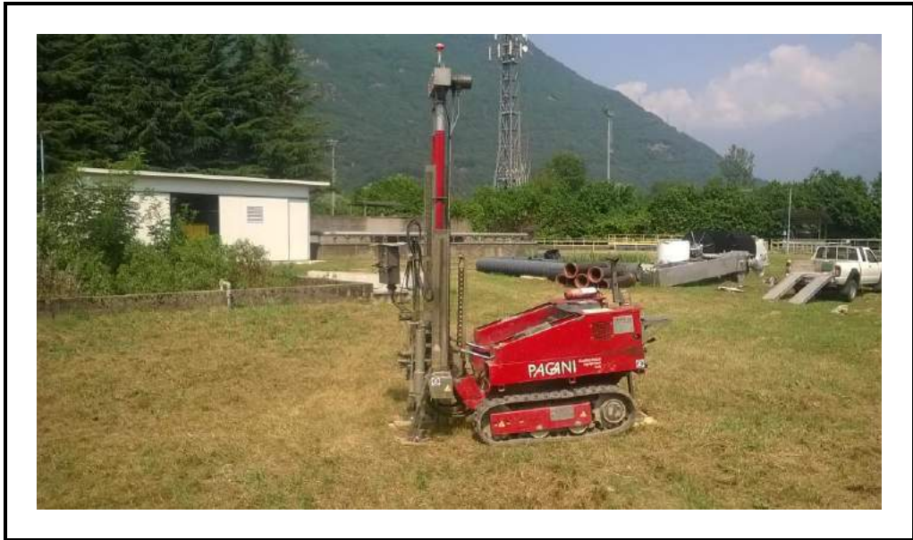
Foto 7: Postazione prova penetrometrica DPSH 1 bis.
