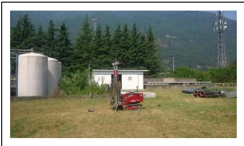
Foto 6: Postazione prova penetrometrica DPSH 1.
